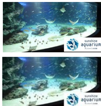
上段:3.9mmピッチのLEDビジョンに映し出した画像イメージ 下段:10mmピッチのLEDビジョンに映し出した画像イメージ
